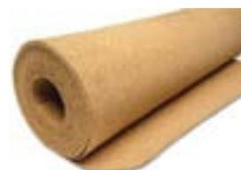
Rotolo in sughero biondo densità 150÷160 kg/m<sup>3</sup> | Conduttività termica dichiarata  $\lambda_D$ [W/(m\*k)] 0,041 | Calore specifico c 1.674 J/kg K
