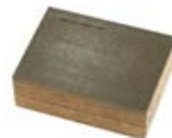
Fibra di legno densità 160 kg/m<sup>3</sup> | Conduttività termica dichiarata  $\lambda_D$ [W/(m\*k)] 0,039 | Calore specifico c 2.100 J/kg K
