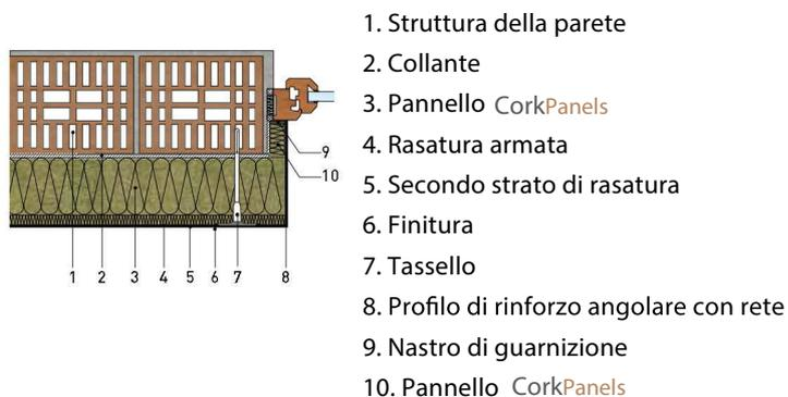
Il dettaglio di raccordo del cappotto termico al serramento montato all'interno della muratura deve essere progettato realizzando una certa continuità d'isolamento anche in corrispondenza delle spallette, al fine di evitare il formarsi di ponti termici.
